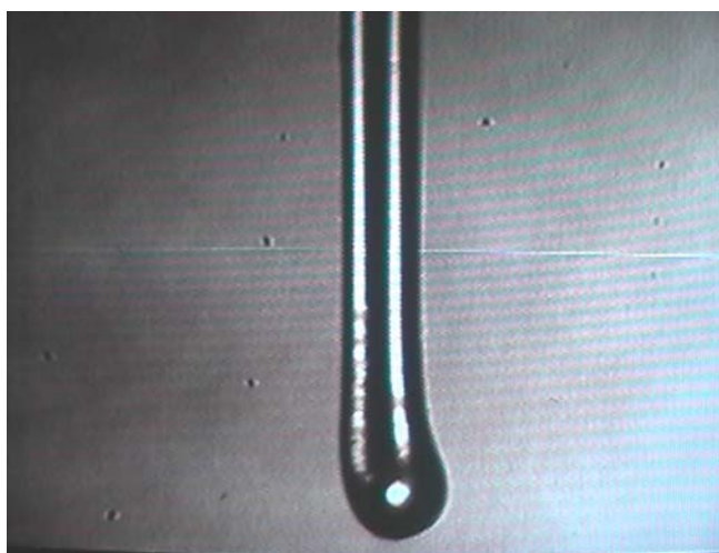
Fig. 2 Semigota formada por la fusión de dos terminales de fibras ópticas (aumentada 220 en monitor).
