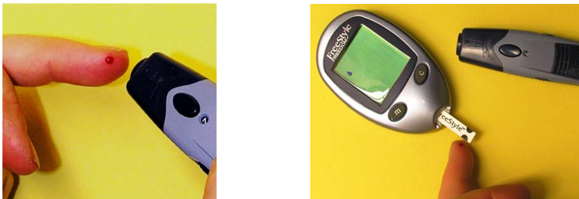
Abb. 3: Anwendung von enzymatisch katalysierten biochemischen Sensoren: Blutglukosemessung mit Teststreifen, welche Diabetiker 4-6 mal täglich durchführen
